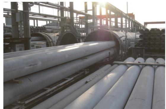
写真 - 4 オートクレーブ養生工程
