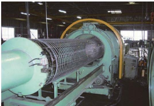
写真 - 1 鉄筋籠の編成工程
