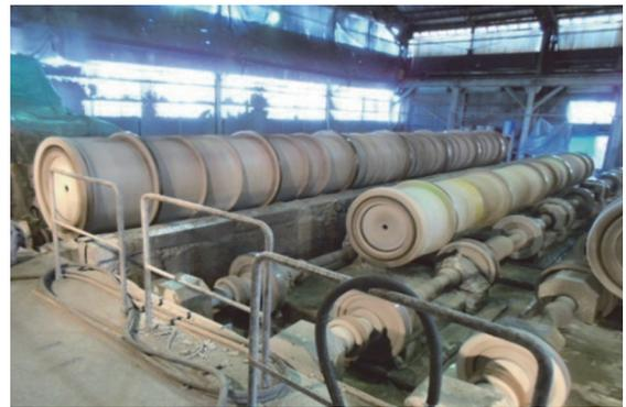
写真 - 3 遠心力成形工程
