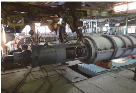
写真 - 2 PC 鋼材緊張工程
