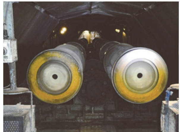
写真 - 4 遠心締固め状況
