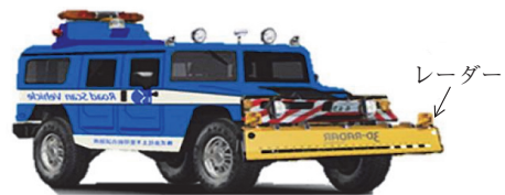
図-11 東大チームの地中レーダー搭載車（時速80 kmの高速で地中からの反射波の非接触計測が可能）
