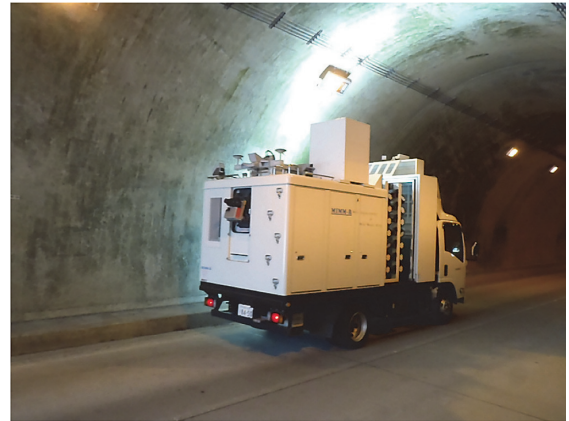
図-10 パシフィックコンサルタンツチームのトンネル検査車両
