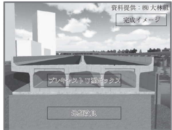
図 - 7 鮫洲埋立部 (更新線) の構造概要
