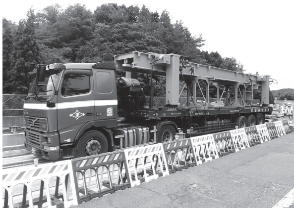
写真 - 7 架設装置の運搬状況
