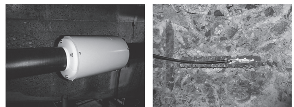
(a) 張力測定装置 (b) 鉄筋応力測定
