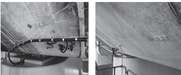
(a) ミニセンサー・腐食センサー・照合電極 (b) ワッペン, 薄板小型モルタル
