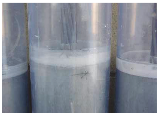
写真 - 6 鉛直管試験におけるフレッシュ性状 (A-1)
