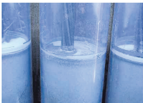
写真 - 7 鉛直管試験におけるフレッシュ性状 (B-1)
