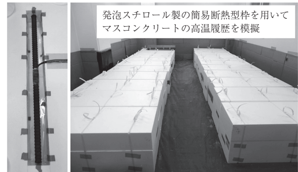
(A) 鉄筋拘束試験の実施状況
