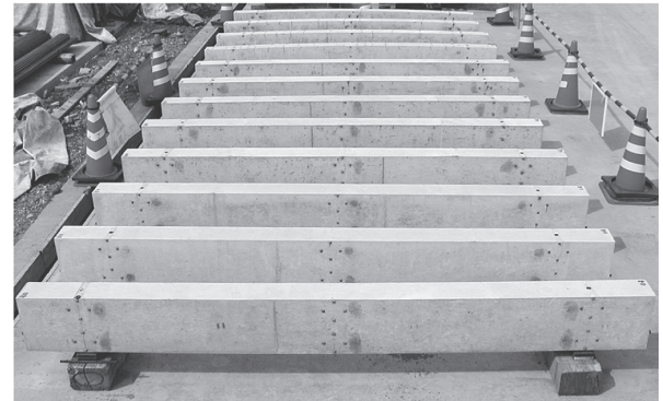
写真-4 PC梁試験体の暴露状況
