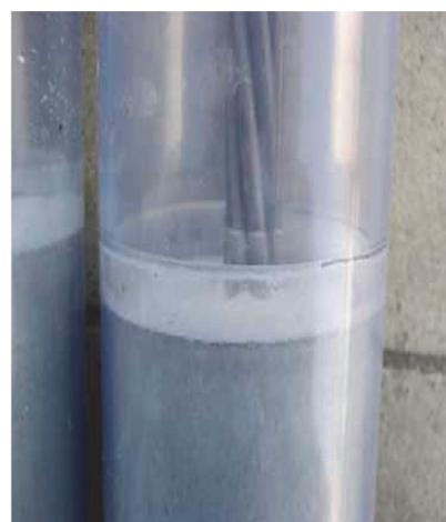
写真 - 3 JH 法における体積変化率測定時の PC グラウト上面
