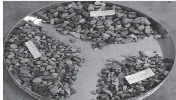
写真 - 2 再生骨材中の原骨材 (旧モルタル分除去後)
