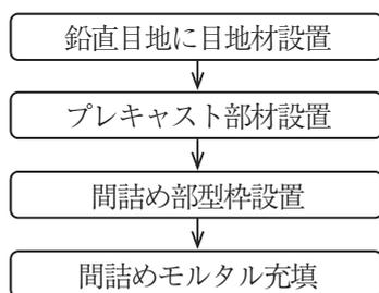
図 - 7 DAK 式壁高欄施工フロー
