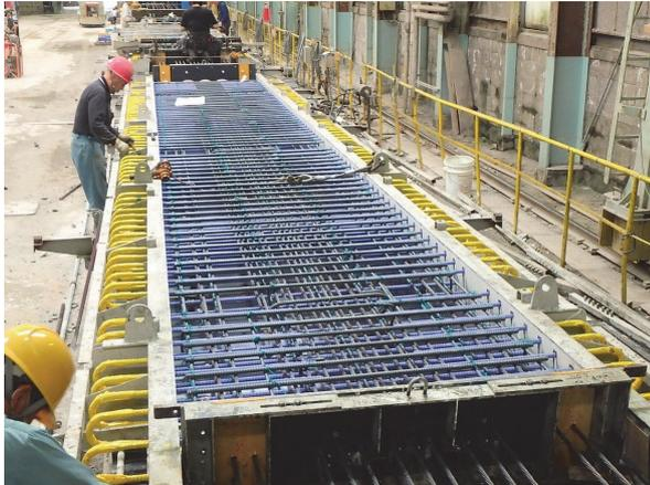
写真 - 11 鉄筋カゴの型枠セット状況
