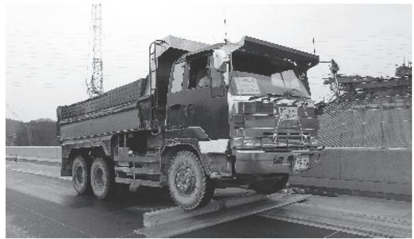
写真 - 8 振動試験実施状況
