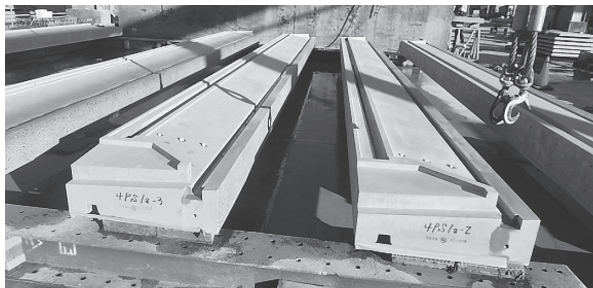
写真 - 5 外装水平ルーバーの製作状況
