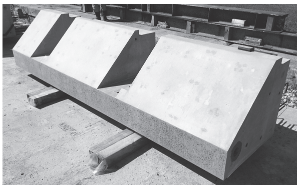
写真 - 6 PCaRC 袖壁の製作状況
