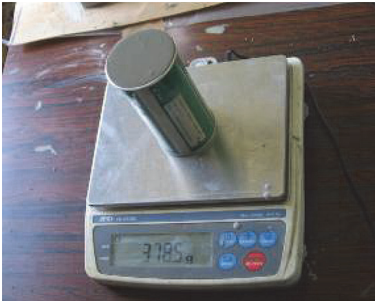
写真 - 4 単位容積質量試験
