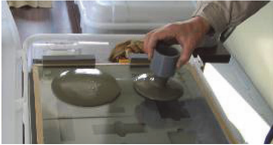
写真 - 3 フロー試験
