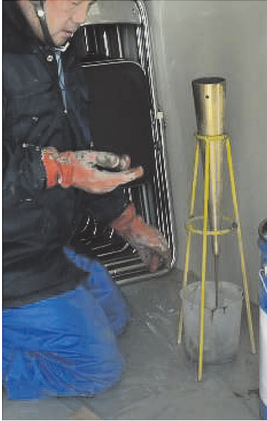
写真 - 2 JP 漏斗を用いた流下時間測定試験
