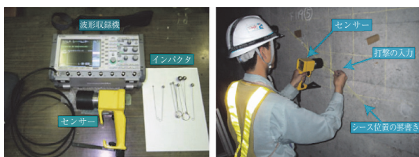
図 - 3 インパクトエコー法 (株)国際建設技術研究所 HP より)
