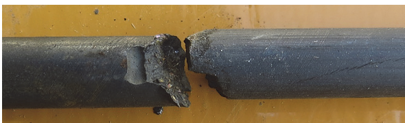
写真 - 4 PC 鋼線の水素脆化割れ試験結果 6)
