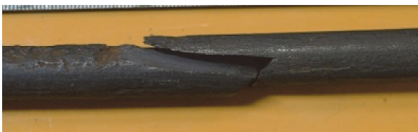
写真 - 3 PC 鋼線の活性溶解型応力腐食割れ試験結果 7)
