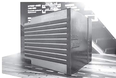
写真-4 積層ゴム支承断面の例
