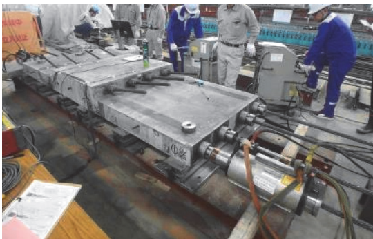
写真 - 2 交差定着部の載荷実験状況
