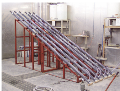
写真 - 4 傾斜管試験状況
