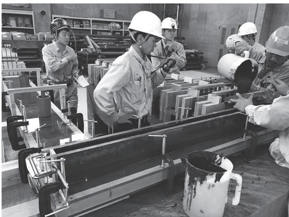
写真 - 2 実物大模型による充填試験
