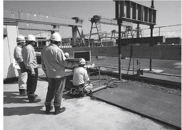
図-13 曲げ耐力試験の状況
