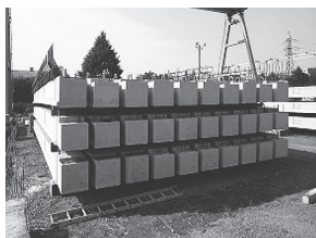
写真 - 1 スラブ桁
