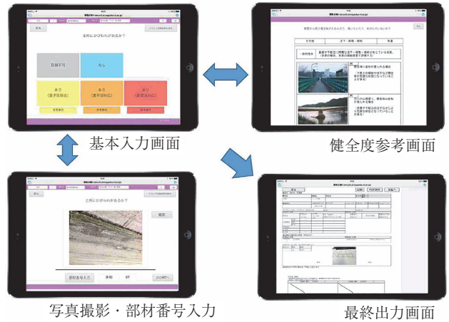
図-4 タブレット端末を活用した定期点検（画面の一例）
