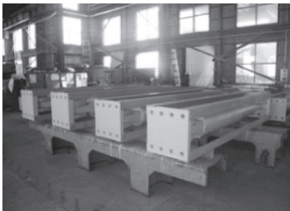
写真 - 11 金属被覆後の制震ダンパー
