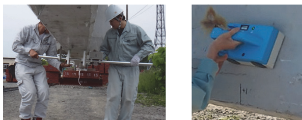
(a) 鋼材の磁化 (b) 磁束密度の測定
