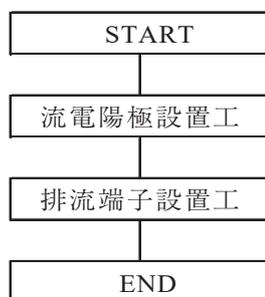
図 - 7 表面設置タイプ流電陽極材の施工フロー
