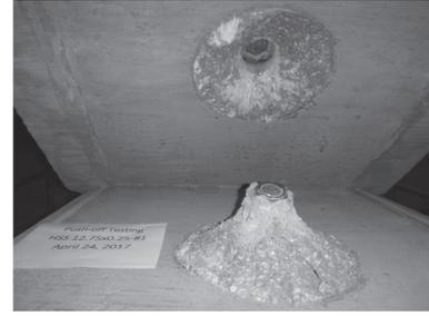
図 - 14 CSP 接合におけるコーン破壊状況
