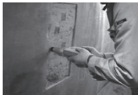
写真-1 テストハンマーによる強度試験
