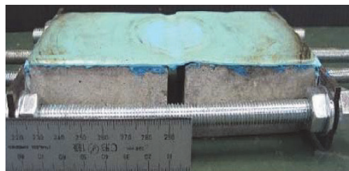
写真 - 4 透水性試験終了後の試験体
