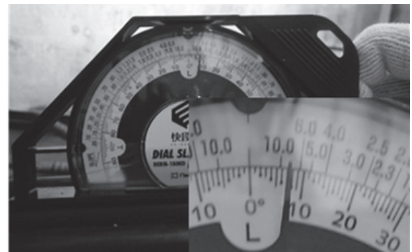
写真 - 4 試験体の曲げ角度確認（7°～7.5°）
