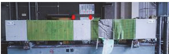
写真 - 1 No.2 試験体の破壊状況
