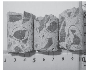
写真-6 粗骨材の状況 写真-7 H橋の損傷状況
