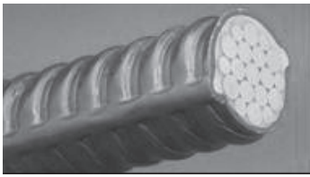
写真 - 5 プレグラウト PC 鋼材の例 (28.6 mm)
