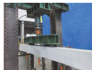
図 - 4 要素試験体の载荷状況
