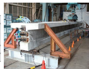
図 - 6 実規模試験体の载荷状況
