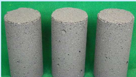
耐酸コンクリート (質量変化率 +1%)
