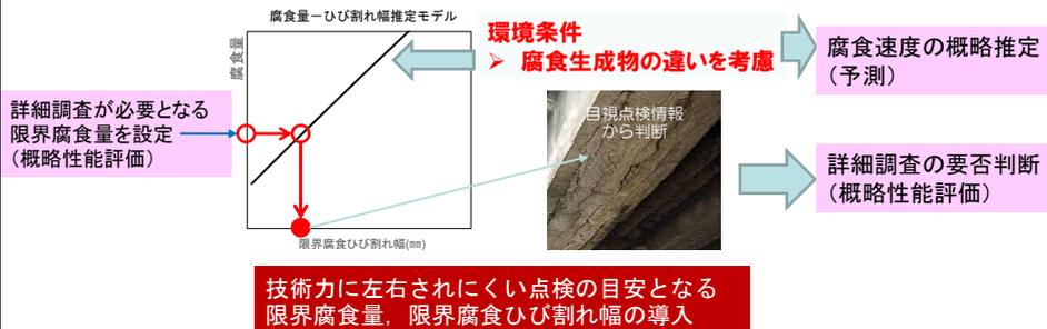
曲げ耐力を指標とした詳細調査要否判定のための腐食量
